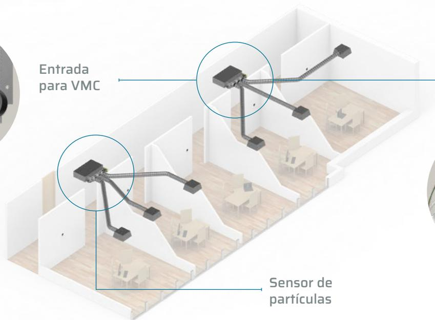
Hasta 8 ionizadores en compuerta
